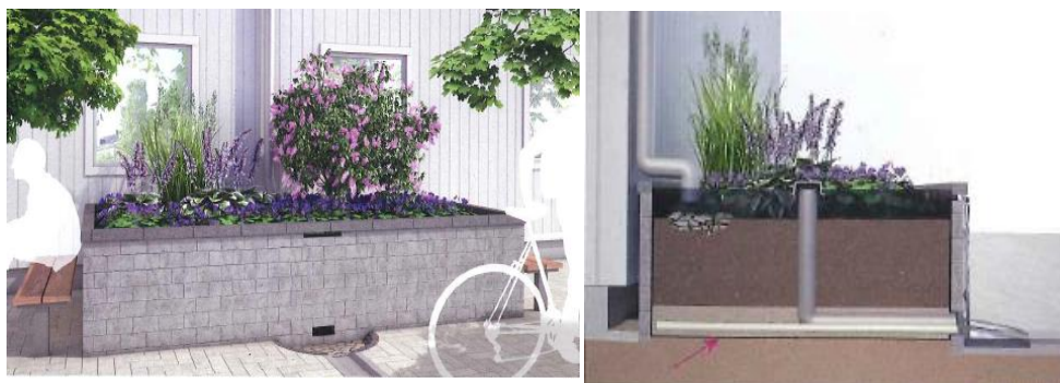
Figur 7 Till vänster: exempelbild på en upphöjd växtbädd/regnbädd. Till höger: sektion av regnbädd med tät duk under så att vatten inte riskerar att skada grundläggning (Movium, 2015).
