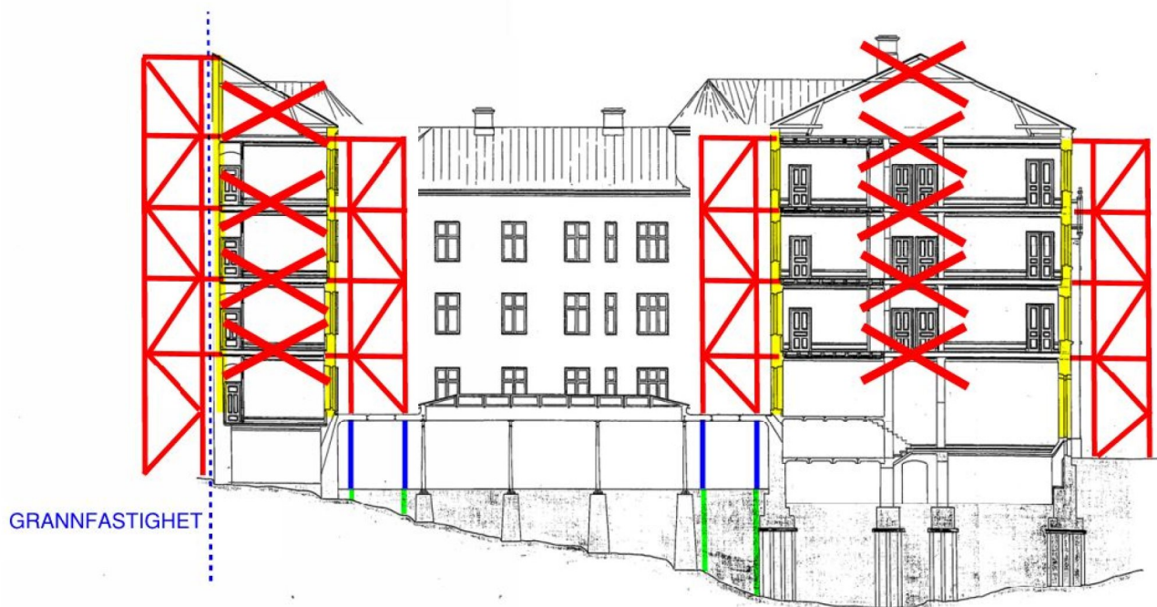
Figur 21: Princip för förstärkning av väggar. Grönt visar tillkommande pålar eller plintar till berg, blått är stämp och rött är stålställning. (2)
