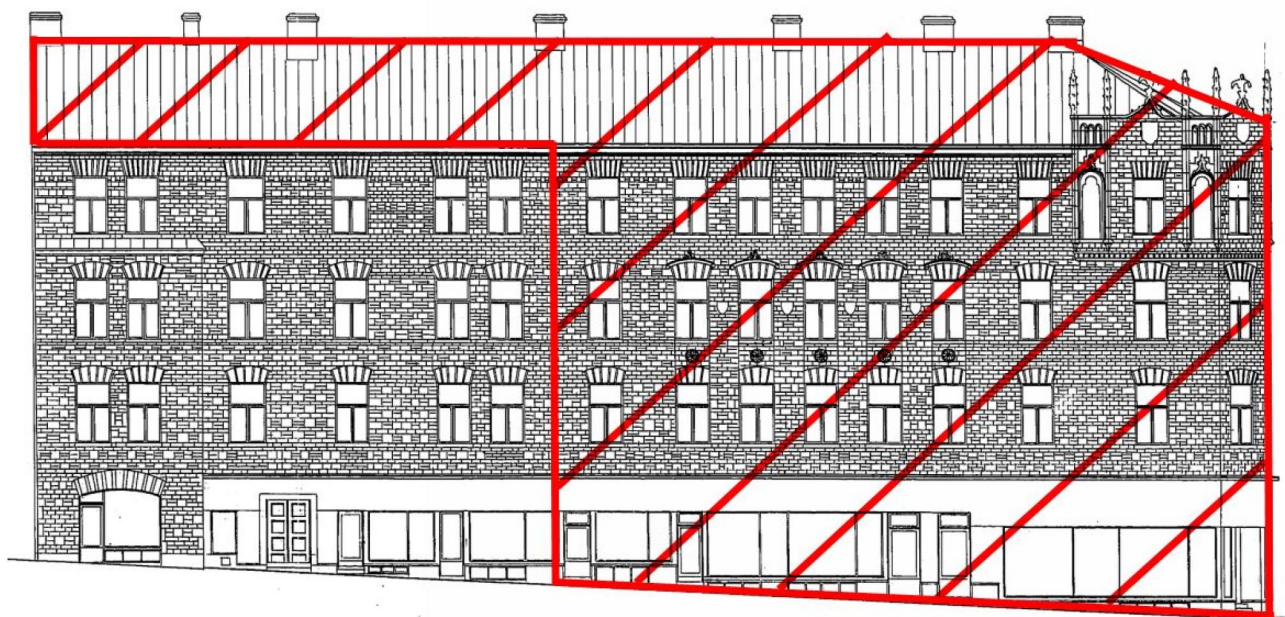
Figur 9: Fasad mot Jakobsbergsgatan. Rödmarkering visar utbränt område bakom fasaden (2)
