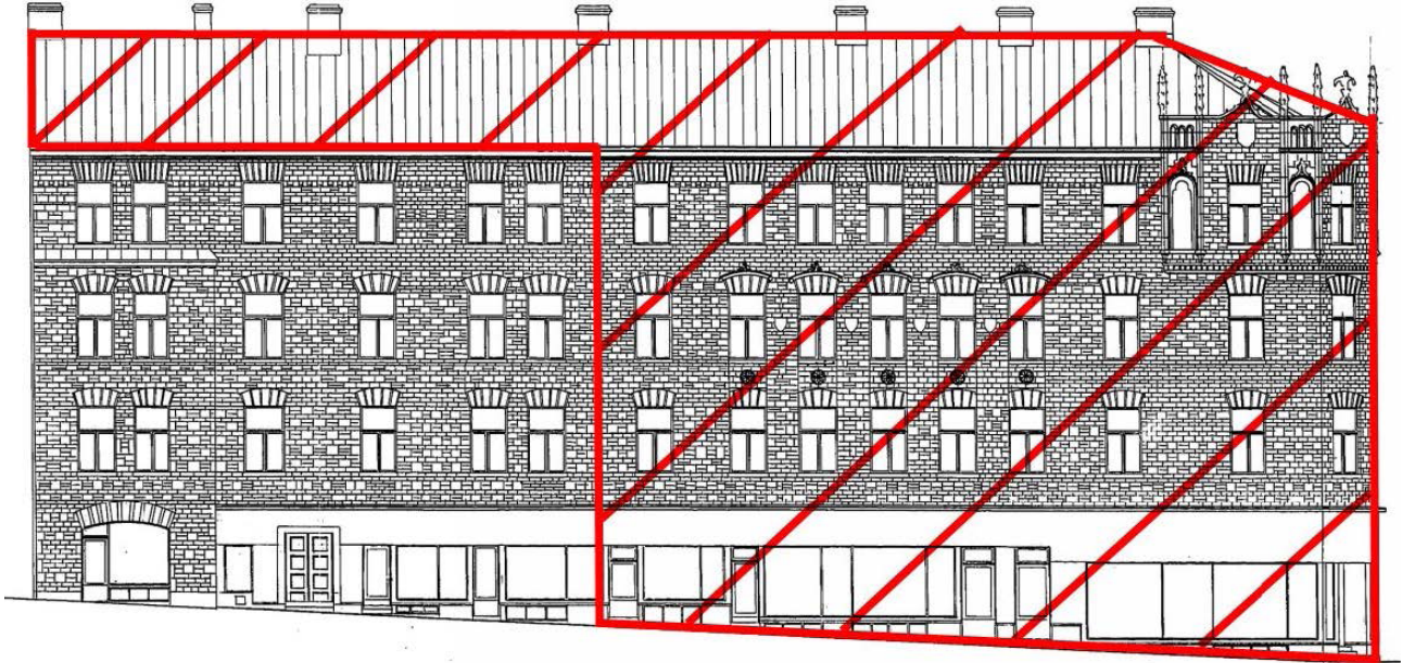
Fasad mot Jakobsbergsgatan. Rödmarkering visar utbränt område bakom fasaden. (Looström|Gehlin)
