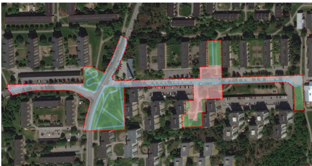
Figur 3. Planerad markanvändning för allmän platsmark. Grönt område motsvarar parkmark, ljusblå markerar gång- och cykelväg, aprikos färg motsvarar torg, gråfärgat markerar gata och rosa övrig gräsyta.
