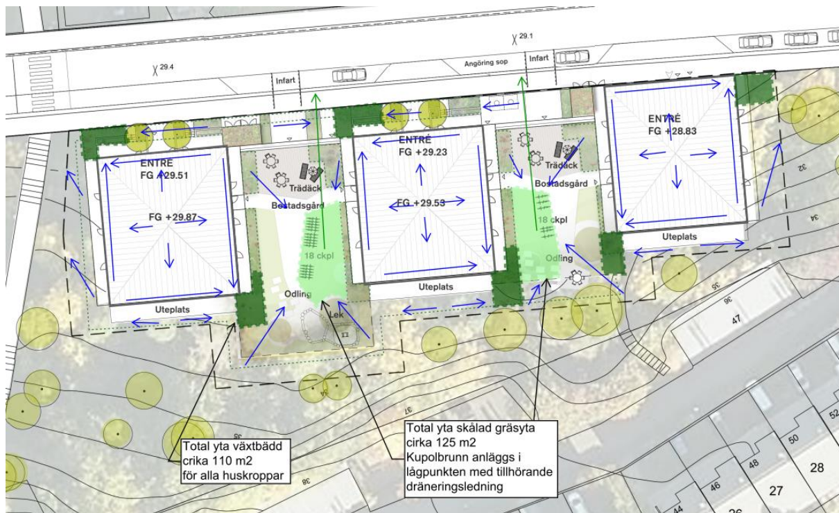
Figur 10. Principlösning för dagvattenhantering för kvarteret. Totalt magasineras cirka 35 m 3 . Mörkgröna ytor motsvarar yta för växtbädd, ljusgröna ytor indikerar yta för skälad gräsyta.
