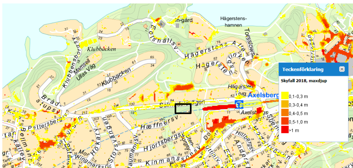
Figur 3. Stockholms stads skyfallskartering över maxdjup som uppstår vid ett 100-års regn med klimatfaktor 1,25. Utredningsområdet markerat med svart.
