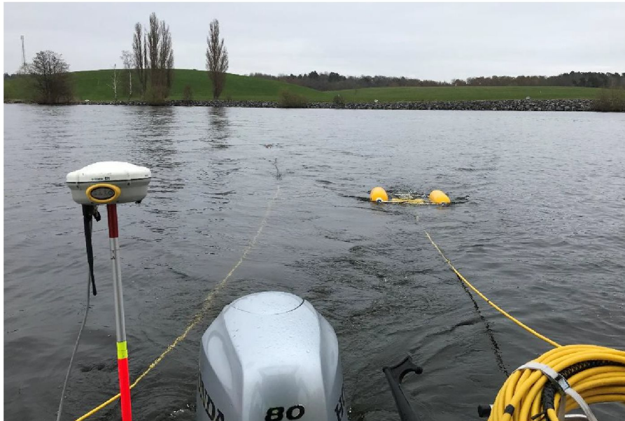
Figur 4: Reflektionsseismik utlägg under mätning
