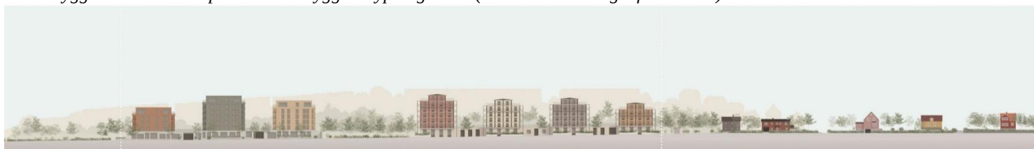
Elevation mot norr, naturmark till vänster och befintliga villor till höger i bild. Illustrationen visar hur byggnaderna har en lägre våningsskala invid villabebyggelsen och hur högre delar centreras för att accentuera formen på norrslutningen. (Illustration av Jägnefält Milton)
