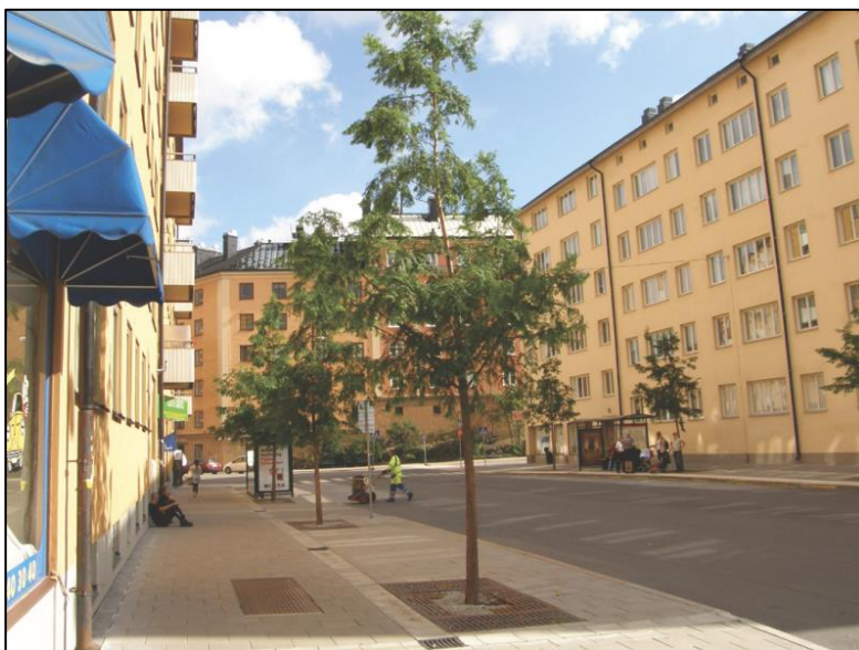
Figur 18. Exempel på trädrad i skelettjord. Dagvatten avleds till skelettjord via dagvattenbrunnar/ luftningsbrunnar. Bild: WRS
