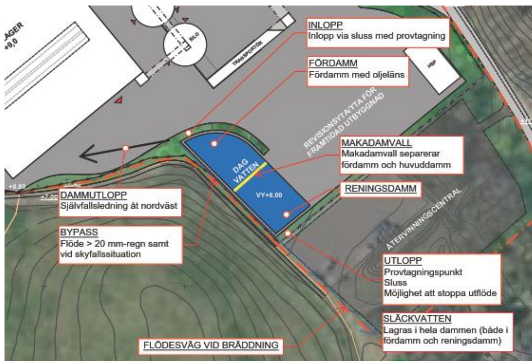
Figur 16 - Utformning dammsystem öst.
