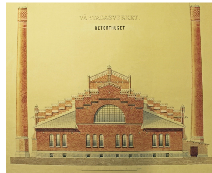
Bild 4: Retorthus I, västra gaveln med dess lägre byggnadsdel samt hus runt skorstenarna längs med södra långsidan. 1890-tal. Källa: SSA
