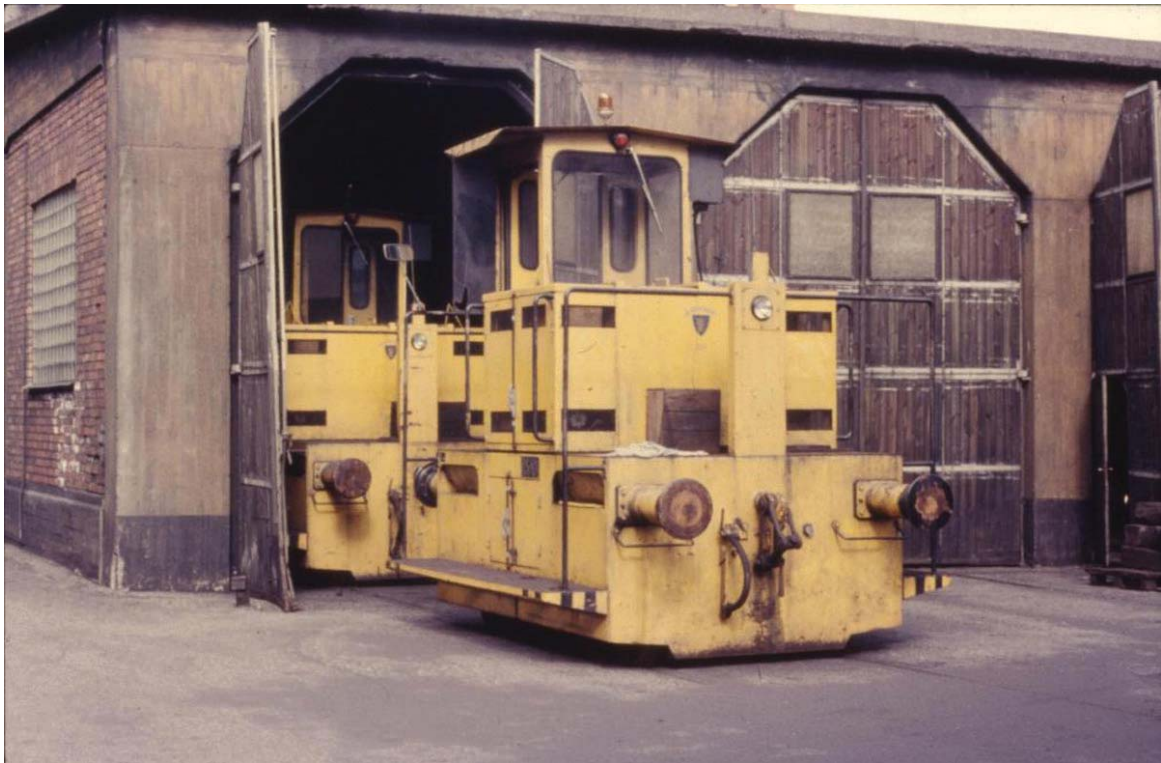
1 Lokstallet från sydväst. 2 Lokstallet 1968 med träportar. Källa: Järnvägsmusei vänner/Järnvägshistoriskt forum. 3 Ackumulatorloket "Suggan". På cylinderns sida syns ventilen för ångladdning. Källa: Stockholms gasverk-Kolepoken är slut 1972.
