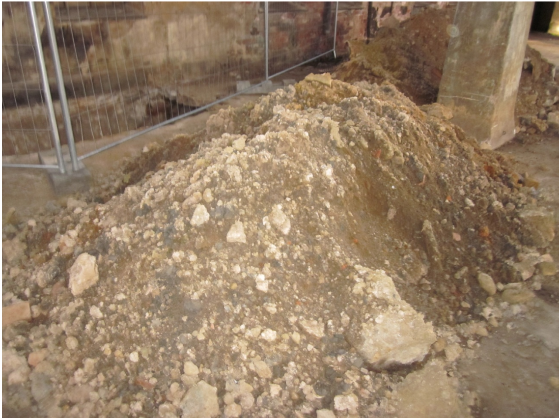
Hus 9 (SLs projekt, provgropar) – Exempel på fyllnadsmassor
