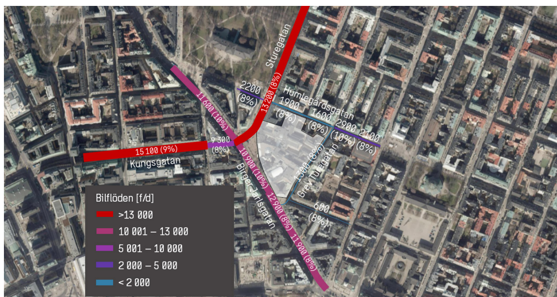
Figur 4: Typisk trafik eftermiddag i området (Karta från Stockholms stad och trafikinformation från Google 2019-04-09).
