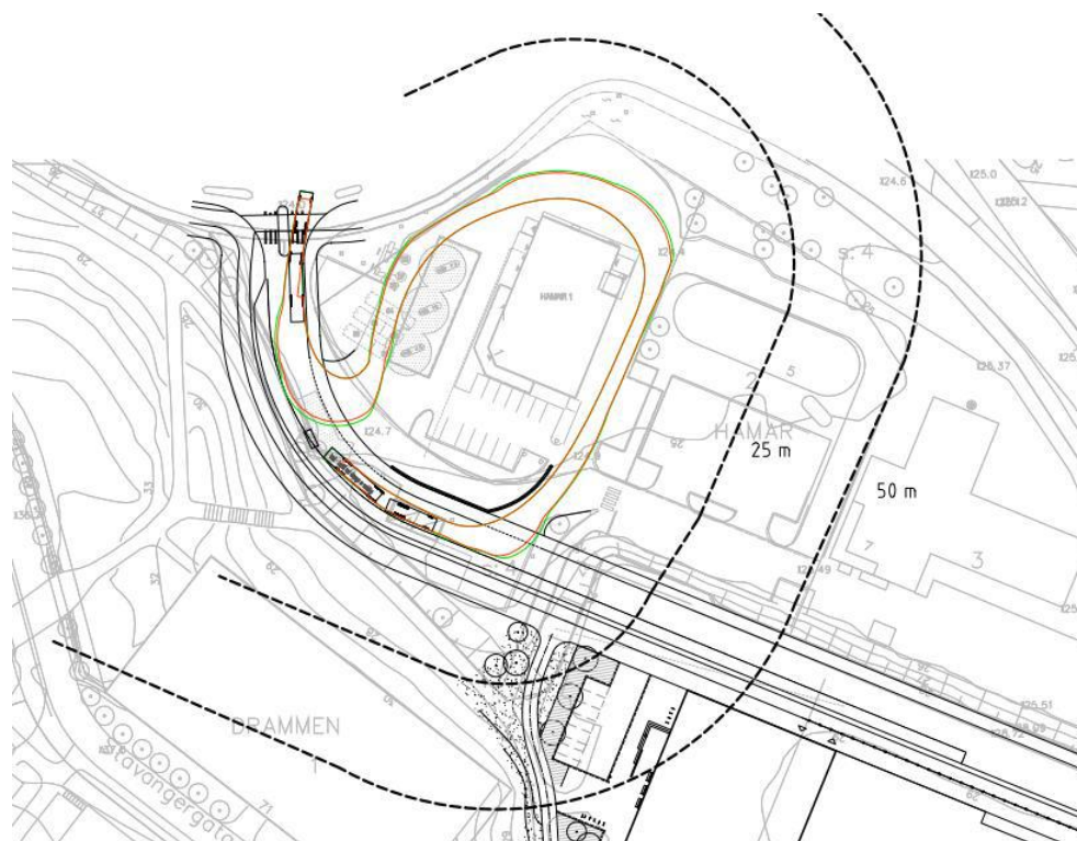
Körspår för tankbilekipage med angivna avstånd, 25 m och 50 m. Bild: SWECO.
