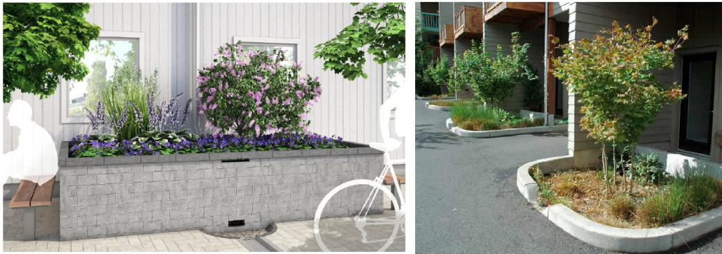
Figur 6 Exempel på växtbäddar för dagvattenhantering tak.
