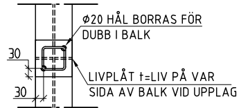
1-1 1:10 FÖRSTÄRKNING SKYDDSRUM PELARE & BALK
