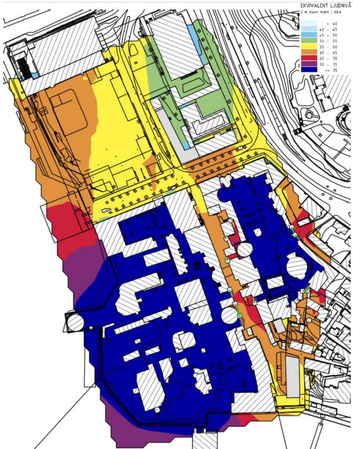
Figur 11. Bullerkarta med ekvivalent ljudnivå i nuläget, 2 meter över mark, under Gröna Lunds öppettider. Mest bullerutsatta bostäder är markerade som grå byggnader.
