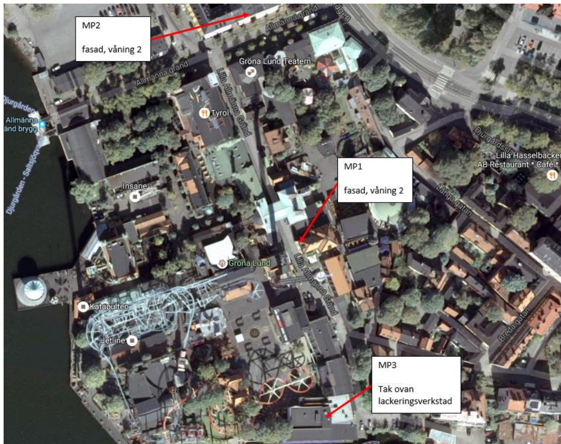
Figur 3: Placering av mätare under loggning av ljudtrycksnivå.
