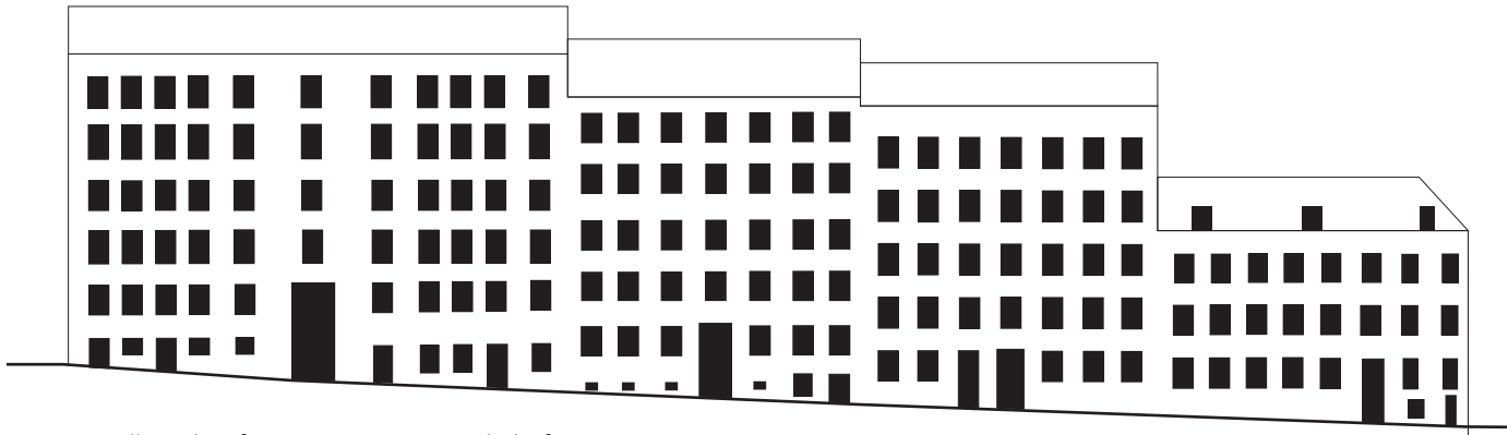
Regelbunden fönstersättning, vertikala fönster
