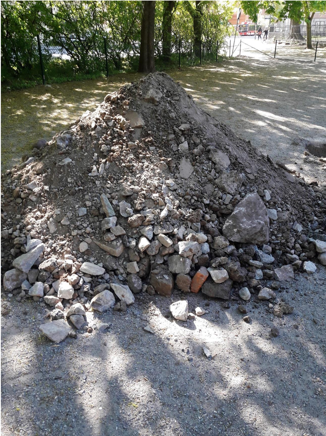
Bild 7: Schaktmassor med tegelrester från provpunkt 19W02.
