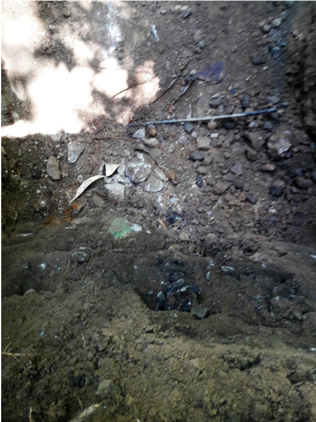
Bild 3: Schaktgrop med tjärasfaltsbitar och rivningsrester från provpunkt 19W01, ca. 0,8 – 1,7 m u my.
