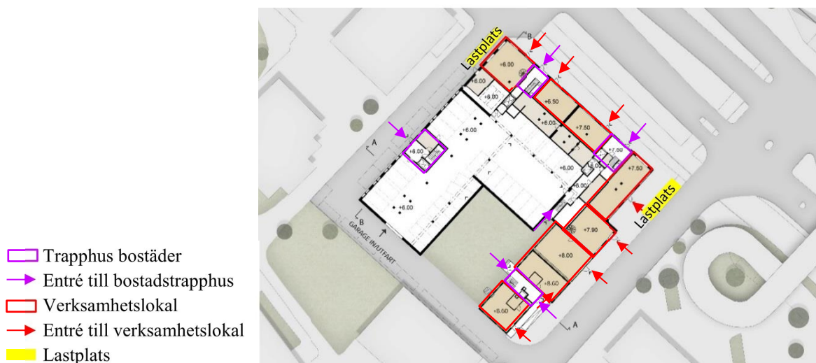
Illustrationsplan över kvarterets bottenvåning med läge för lastplatser i förhållande till bostadsentréer och entréer (Arkitema Arkitekter).
