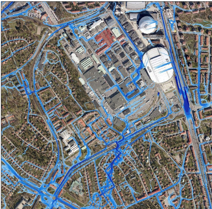
Figur 8: Nulägesmodellering: Beräknade maximala flöden (m 3 /s/m) under hela simuleringen vid ett klimatkorrigerat 100-årsregn.
