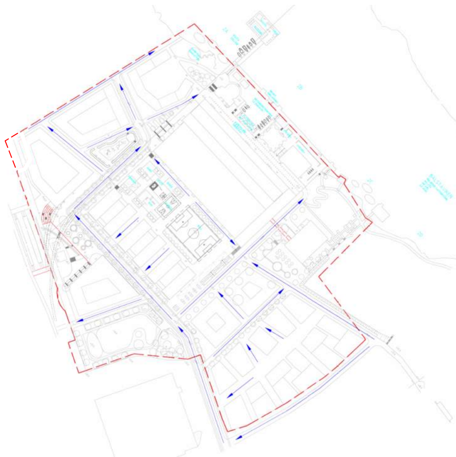
Figur 32. Översiktliga ytliga rinnstråk vid skyfall inom planområdet. Planområdesgräns är markerad med streckad röd linje.
