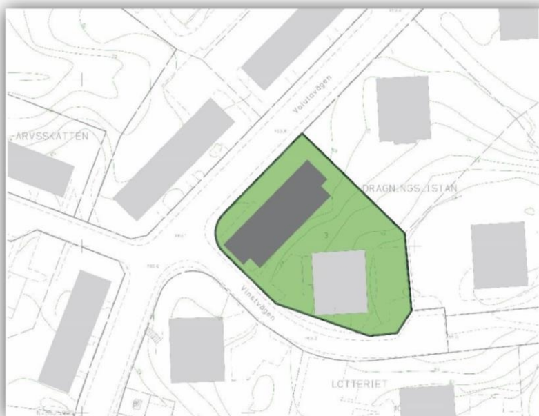
Situationsplan som visar fastigheten Dragningslistan 3 med sitt punkthus och det nya lamellhuset utmed Valutavägen.
