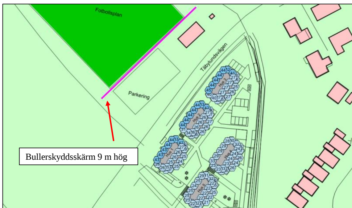
Figur 5. Exempel på placering av bullerskyddsskärm för att erhålla högst 45 dBA vid de närmaste bostadsfasaderna.
