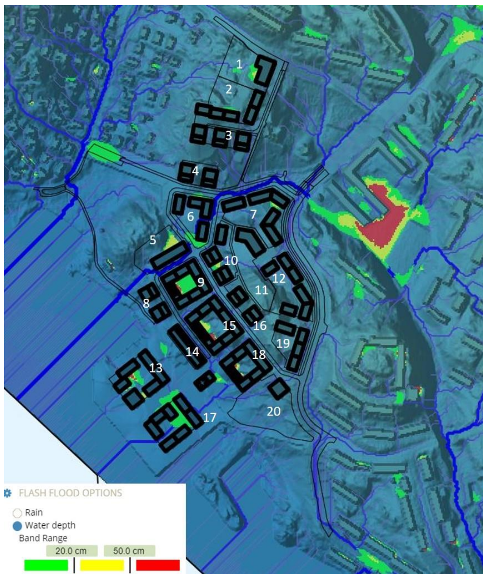
Figur 14 Maximalt vattendjup och flödesvägar vid ett 56 mm regn. Planerad bebyggelse markeras med fet svart linje, planerade vägar med svart linje och nya kvarter markeras med siffror 1-20. Kartan skapades med Scalgo Live (2019).
