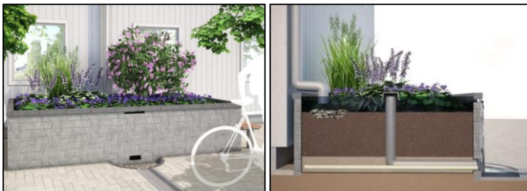
Figur 18 & 19. Exempel på upphöjd växtbädd som tar emot dagvatten från tak via stuprör (Vinnova, 2014).
