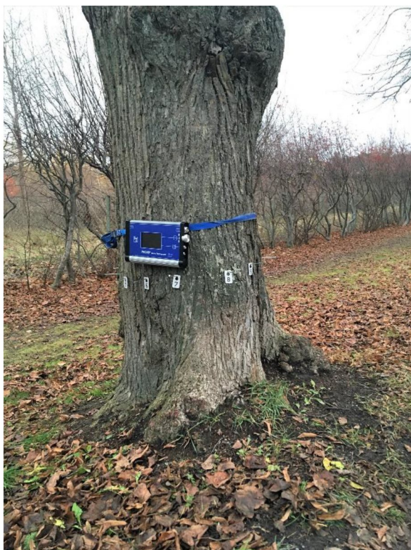
Bild 29 Undersökning med Picus Tomograph vid 50 cm
