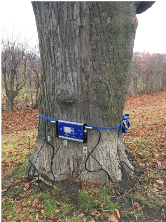
Bild 3 Undersökning med Picus Tomograph vid 30 cm
