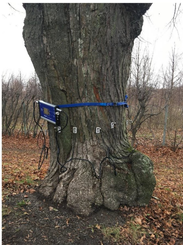
Bild 7 Undersökning med Picus Tomograph vid 70 cm
