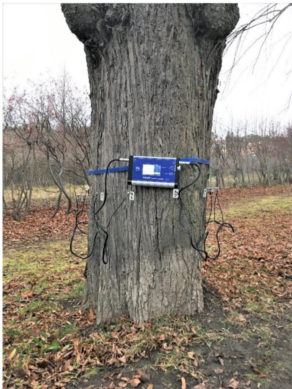
Bild 25 Undersökning med Picus Tomograph vid 75 cm
