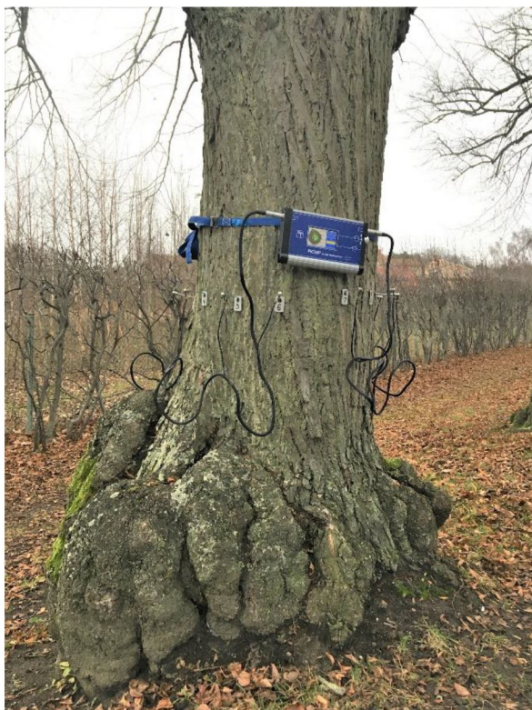
Bild 11 Undersökning med Picus Tomograph vid 95 cm
