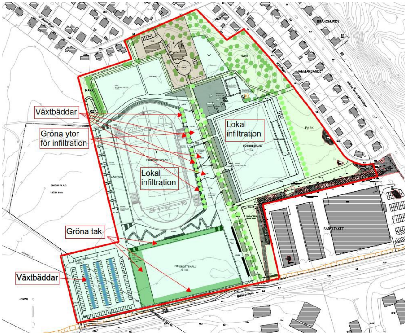
Bild 20. Föreslagen generell placering av dagvattenanläggningar i området.
