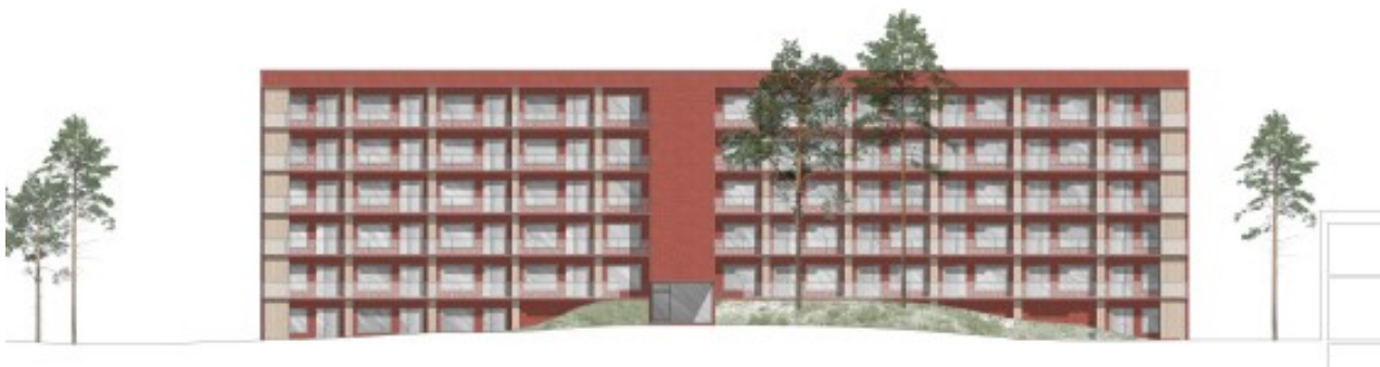
Figur 13. Fasad för hus A. Möjlig utformning av fasad med loftgångar mot gården. Bild: Arkitema Architects.
