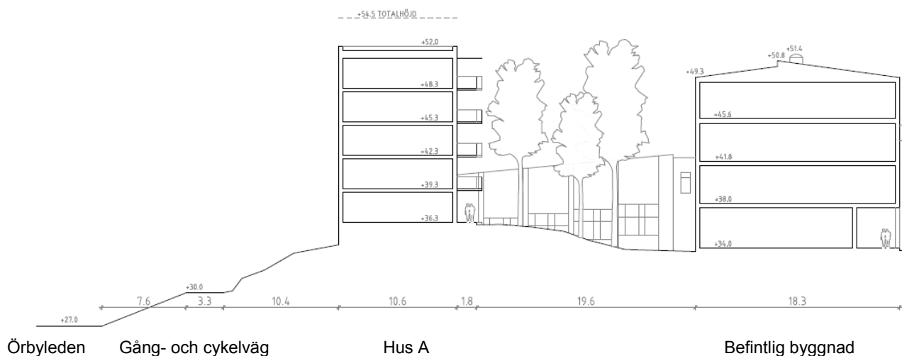
Figur 11. Sektion för hus A om visar förhållandet till det nya gårdsrummet där det är som störst, gång- och cykelvägen, Örbyleden samt den befintliga byggnaden. Bild: Arkitema Architects.
