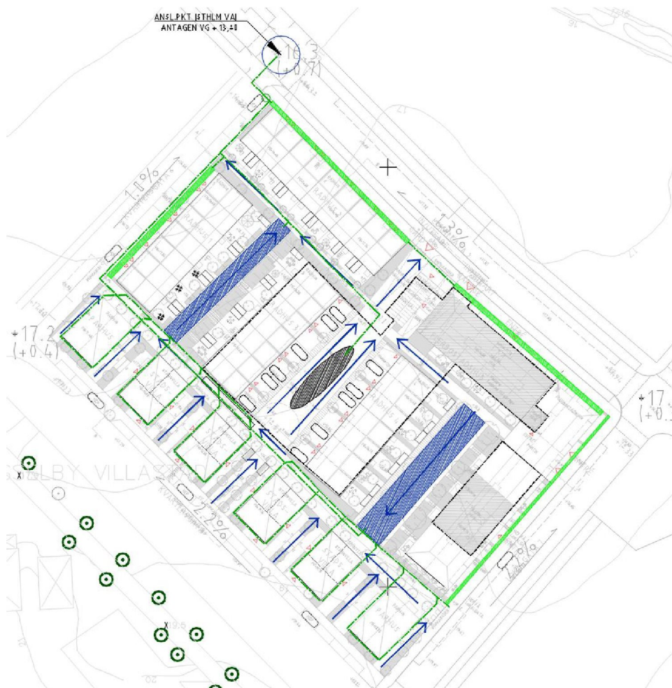
Figur 24. Föreslagen dagvattenlösning för kvarter 5. Ljusgrönt markerar yta som tas om hand i växtbäddar. Blå markerar yta för underjordiska/nedsänkta dagvattenmagasin. Svartskrafferaden område visar nedsänkt yta. Svart streckad linje visar utbredning av underjordiskt garage.
