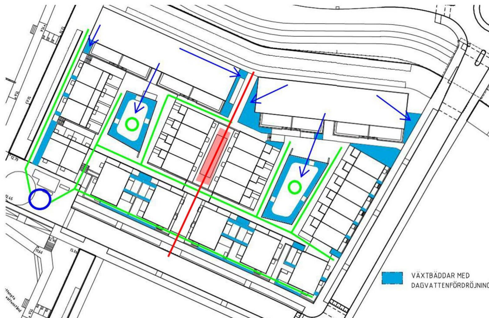
Figur 27. Föreslagen dagvattenhantering. Gröna ringar visar plats för underjordiska magasin. Gröna streck visar ledningar. Blå ring visar anslutningspunkt. Rött område visar plats för nedsänkt yta. Röd linje visar projekterad spillvattenledning.
