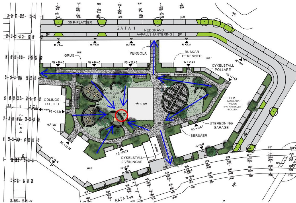
Figur 35. Skyfallsvägar inom kvarter 2. Blå pilar visar vattnets rinnvägar. Röd cirkel markerar lågpunkten på innergården.
