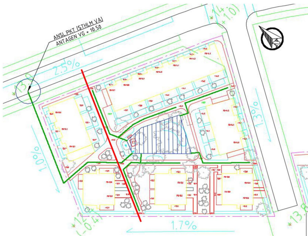
Figur 28. Föreslagen dagvattenhantering för kvarter 9. Dagvattenmagasin i blått på kvarter 9 innergård. Gröna linjer visar dagvattenledningar. Röd linje visar projekterad spillvattenledning.
