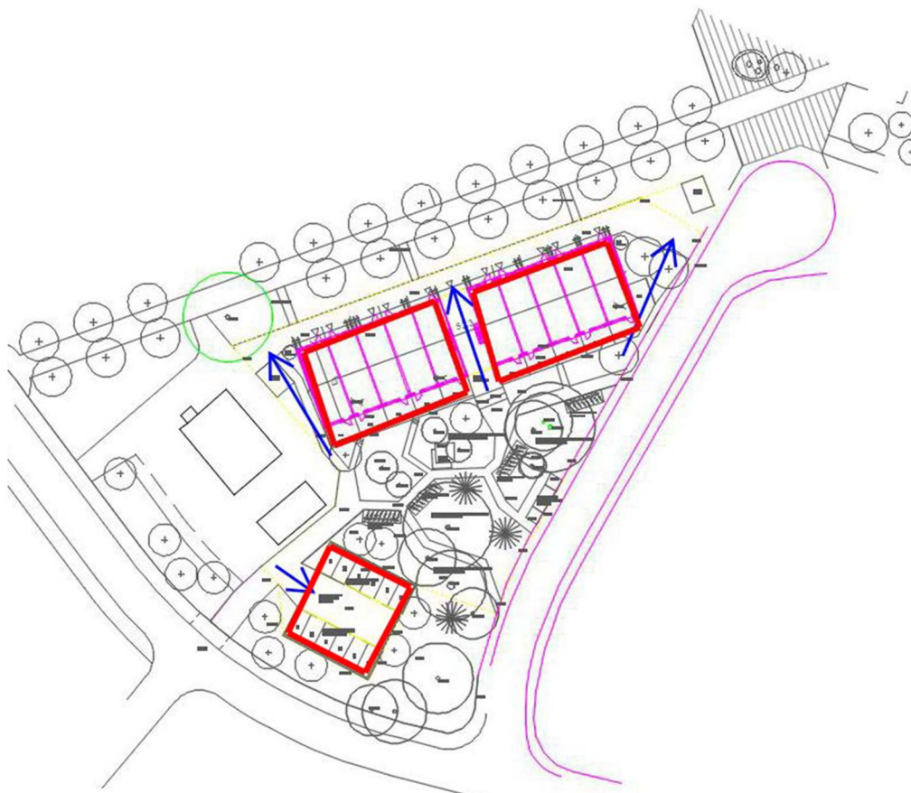
Figur 34. Skyfallsvägar inom kvarter 1. Blå pilar visar vattnets rinnvägar. De röda linjerna visar instängda lågpunkter.
