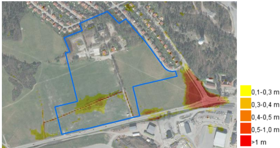
Figur 9. Kartan visar maximalt vattendjup för marköversvämning vid ett 100-årsregn med utredningsområdet markerat i blått.
