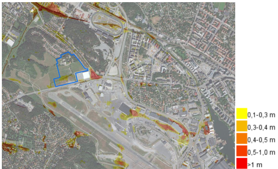
Figur 10. Kartan visar maximalt vattendjup för marköversvämning vid ett 100-årsregn inkluderat ett större område och med utredningsområdet markerat i blått, enligt stadens översvämningsskartering.
