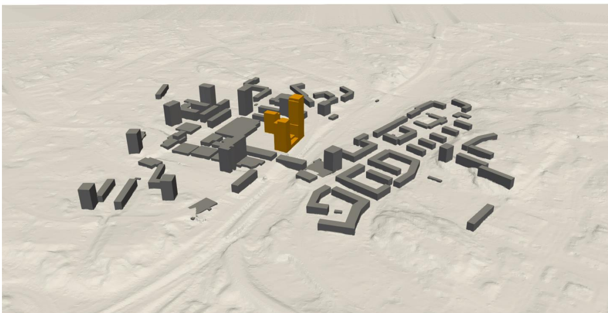
Figur 4-1: Det aktuella beräkningsområdet med inkluderade byggnadsgeometrier. I höjdlängd sträcker sig beräkningsvolymen ca 200 meter över den högsta byggnadens tak.
