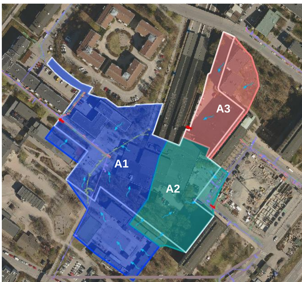
Figur 4. Översikt över befintlig avvattning inom planområdet. Avvattningen visas med blå flödespilar. Röda pilar indikerar utloppen. Planområdet är markerad med vit linje. Befintliga dagvattenledningar markerade med grön linje.
