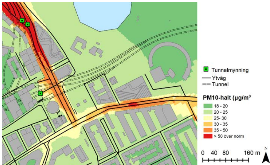
Figur 6. Beräknad dygnsmedelhalt av partiklar, PM10 under det 36:e värsta dygnet för utbyggnadsalternativet år 2025.
