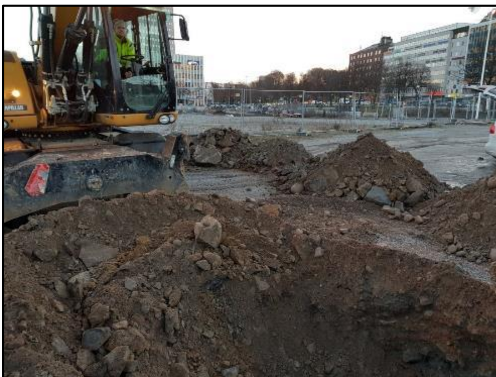
Figur 10: Provgrop 17GAPG17. Bild visar hur material separerades halvmetersvis inför provtagning.
