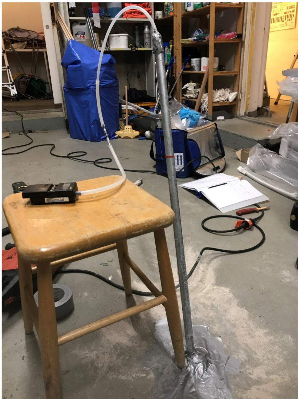
Figur 9. Uppställning av porgasmätningstrustning i förrådsutrymme på våning 2.
