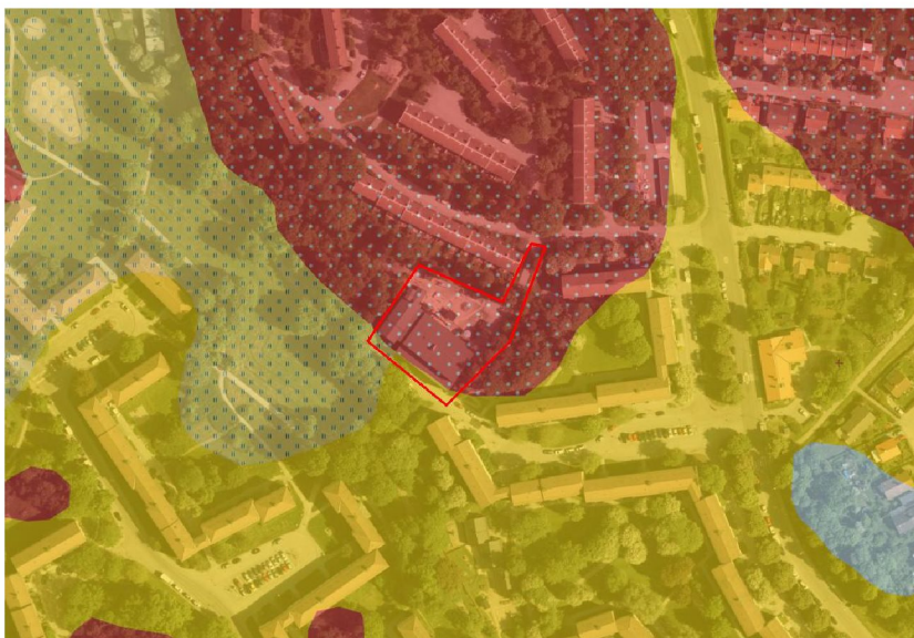
Figur 7. Jordarter inom fastigheten. Gult område visar på glaciallera, rött på urberg, rött med prickar på morän belägen på urberg, gult med prickar på gyttjelera och blått sandig morän. (Källa: Sveriges geologiska undersökning, SGU) Norr är uppåt i bild.
