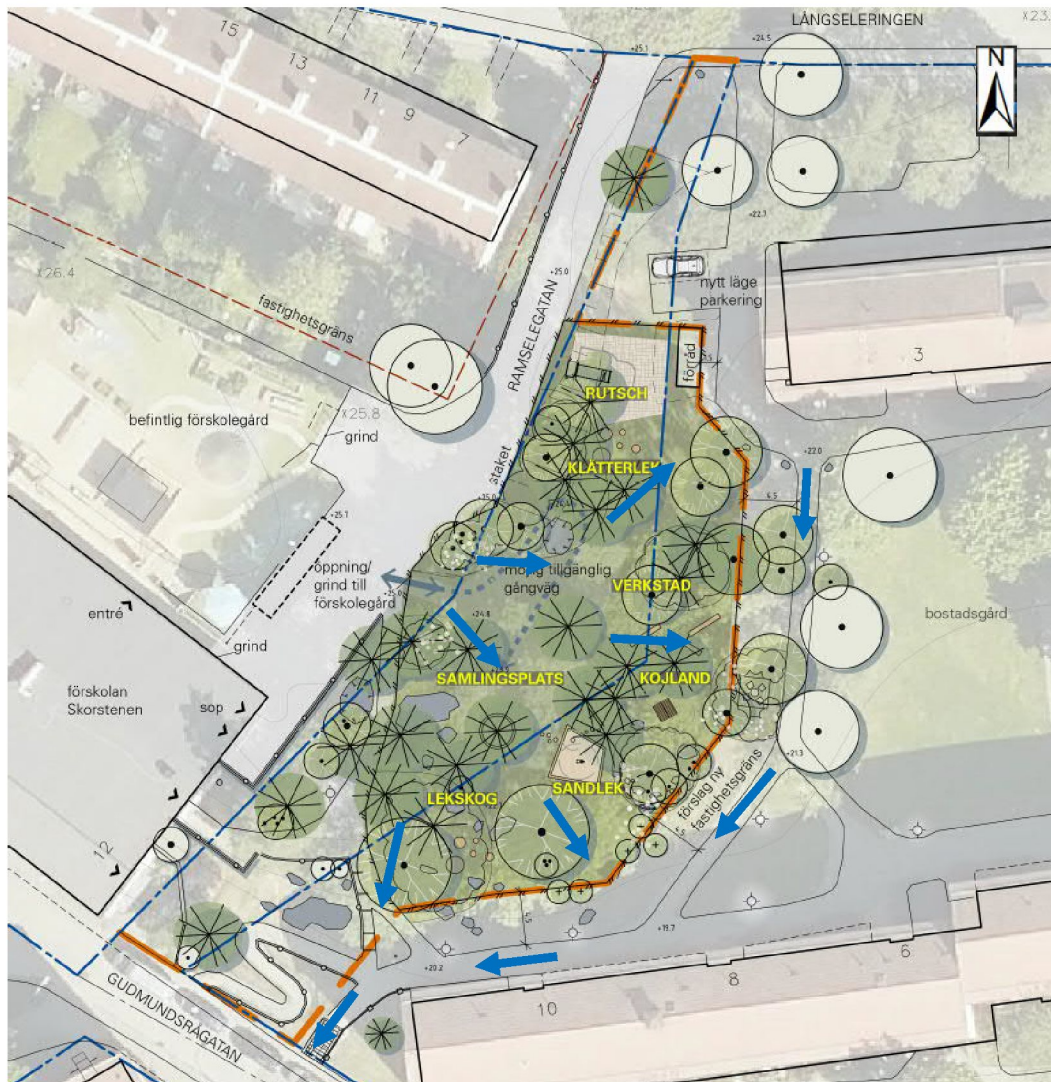
Figur 2. Område efter omdaning (programskiss Karavan landskap, 2019-05-10). Inlagda blå pilar visar generell marklutning och ytlig rinniriktning för dagvatten.
