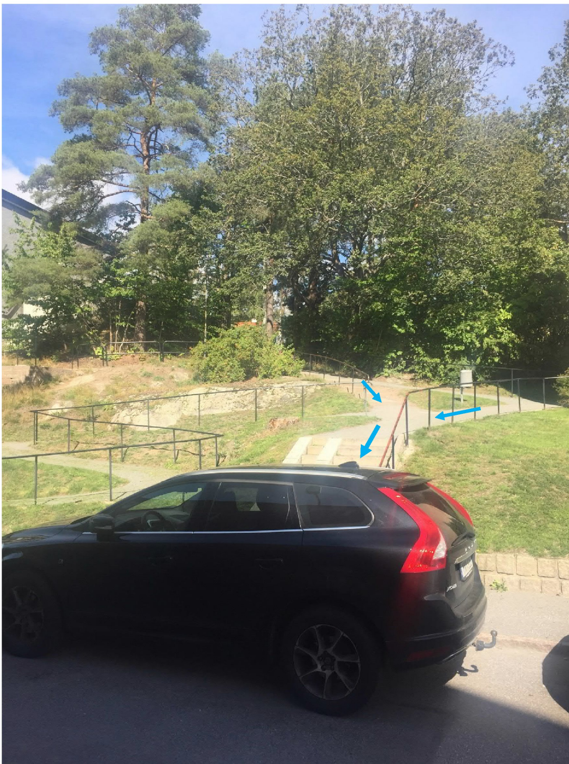
Figur 1. Foto från söder mot utredningsområdet. Fotografi taget från Gudmundraågatan. Trappan ner mot gatan är yttlig rinnväg för dagvatten från förskolegården vid intensiv nederbörd.
