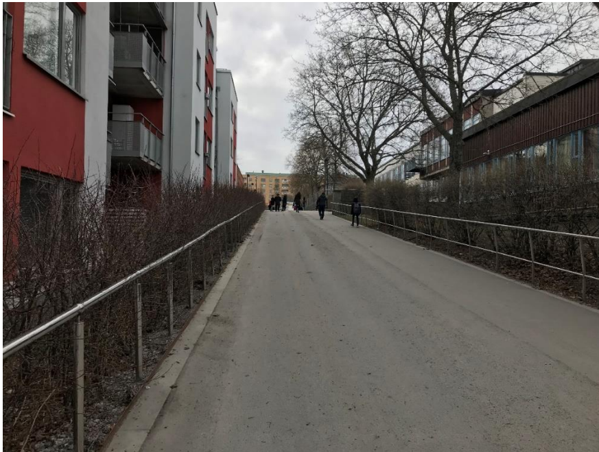
Figur 9 Hållsättrastigen, foto taget i riktning mot Sätora centrum. Hållsättrastigen har en otillgänglig lutning på denna sträckan, där räcken troligen är implementerat för att förbättra tillgängligheten på stråket. Räckena har även infälld belysning.
