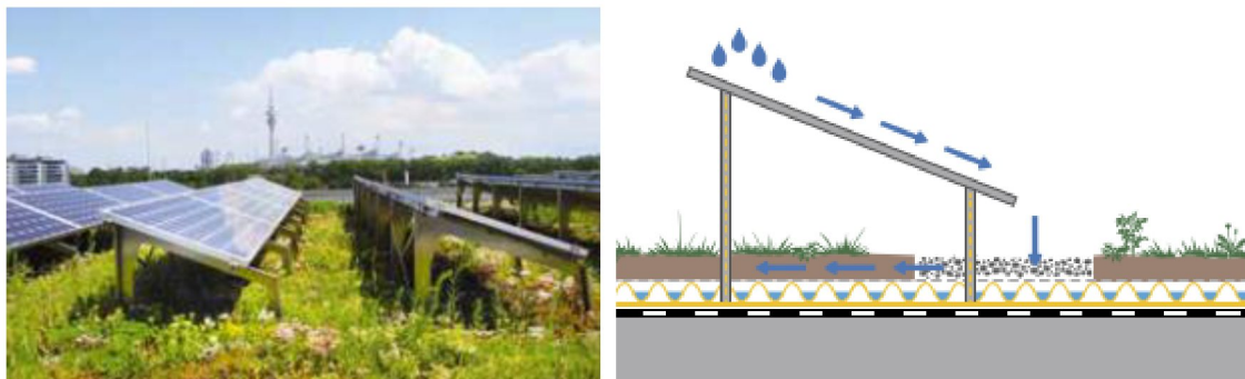
Figur 5. T.v. Fotografi över gröna tak i kombination med solceller. T.h. Illustration över solpanel på stativ och gröna tak med remsa av singel i solpanelens nederkant 7 .
