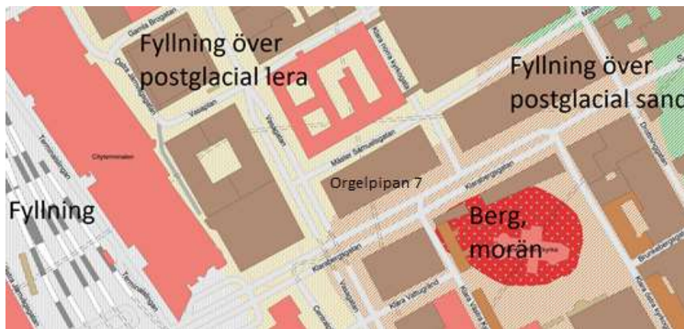
Figur 2. Jordarter inom Orgelpipan 7 (fyllning över postglacial lera/sand) och dess omgivning (urberg och osammanhängande morän, samt fyllning). (SGU, 1961)
