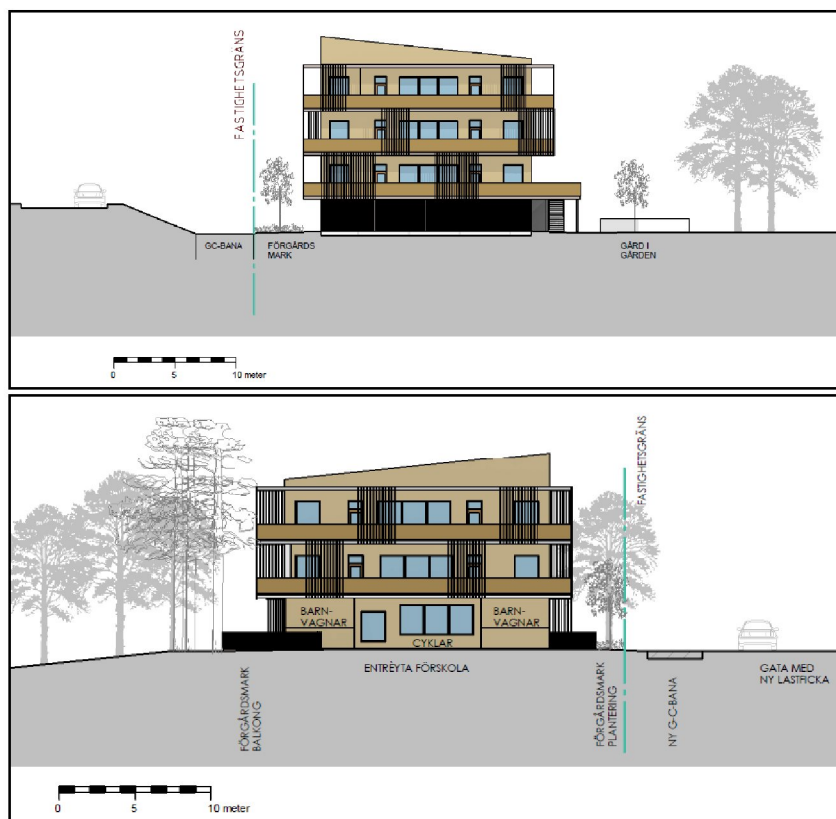
Bild 16 och 17. Gavelfasader, sett från sydväst (överst) respektive nordöst. I den övre bilden framgår att den befintliga topografin beaktas, vilket möjliggör ett suterrängplan med förråd och teknikutrymmen längs byggnadens sydvästra del (förstudie NIRAS).
