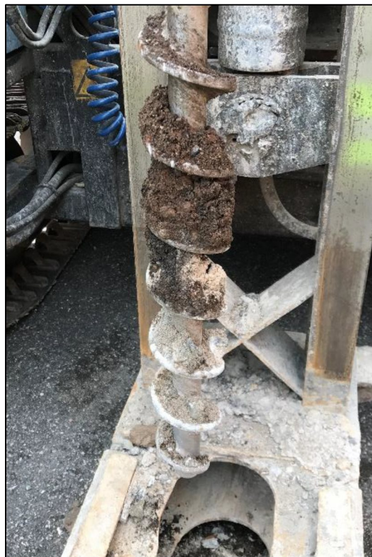
Figur 3-2. Skruv 17GS06 med två olika jordlager.
