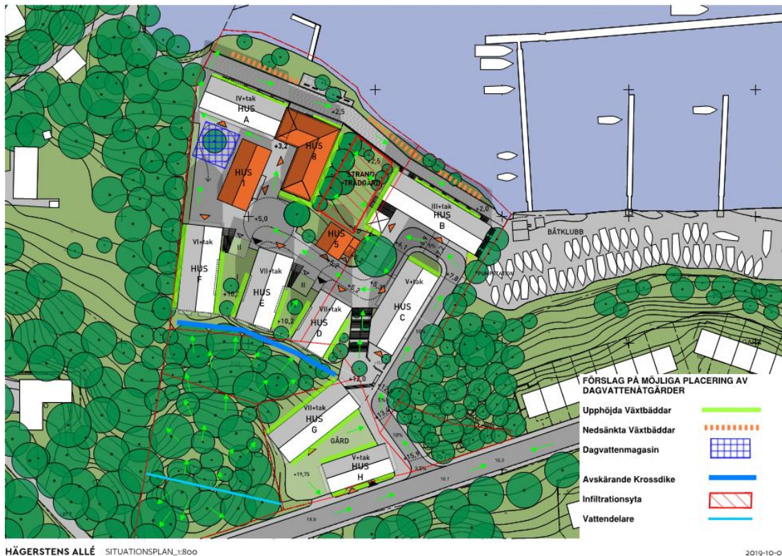
Figur 7. Avvattningsplan och redovisade förslag på dagvattenåtgärder. (Situationsplan 2019-10-03)
