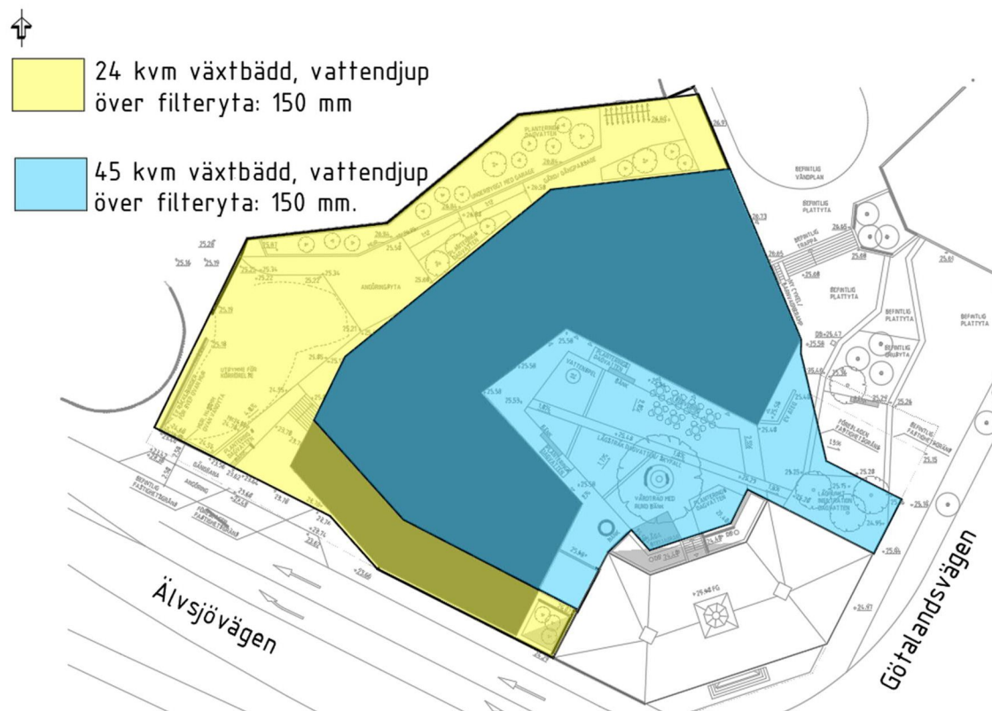
Figur 8. Avrinningsområden för växtbäddar för rening av dagvatten från takytor för att uppnå Stockholms stads åtgärdsnivå. Växtbädd utformas med 150 mm vattendjup över filteryta och dränhastighet på 100 mm/h. (Illustrationsplan i bakgrunden tillhandahållen av SWMS ARKITEKTUR 2020-02-14).
