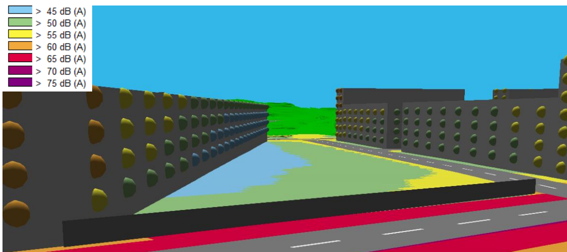
Figur 23. Beräkningsresultat, vy frifältskorrigerad dygnsekvivalent ljudnivå vid fasad dB(A). Skola B samt förslag på skärm ur motsatt vinkel. Alternativt kan skolan få en tillbyggnad mot bussgatan istället för skärmen.
