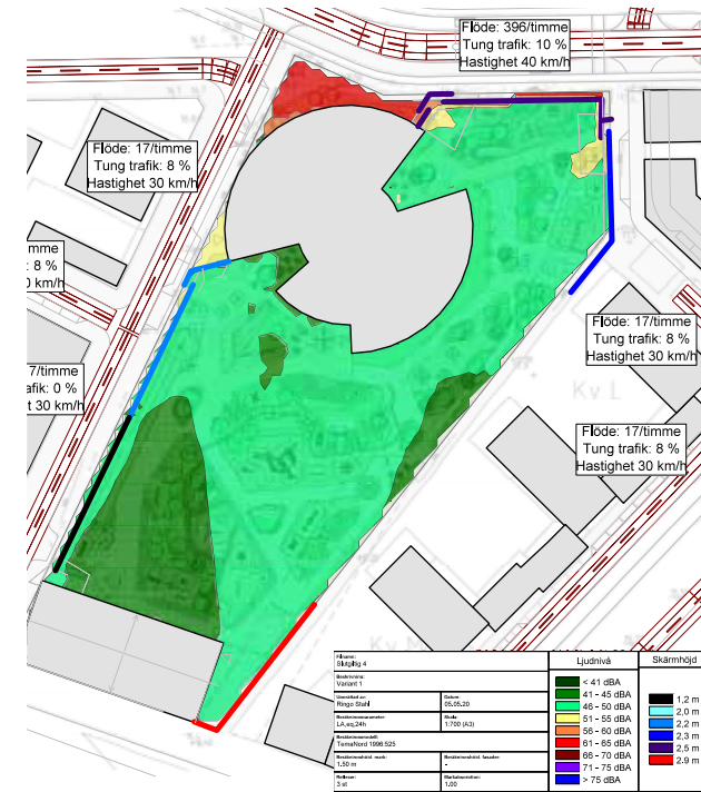
Figur 33. Kvarter J, skolgården med ett av förslagen på vad bullerskydd och ljudslussar ger för effekt på ljudnivån på skolgården. Källa: LN Akustikmiljö.
