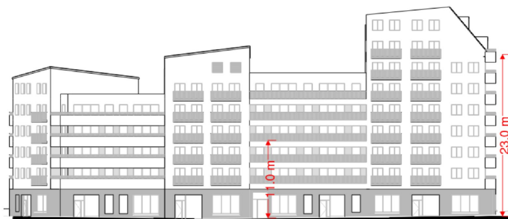
Figur 4. Fasad södra delen. 11 meter nås med bärbara stegar, 23 m nås med höjdfordon.
