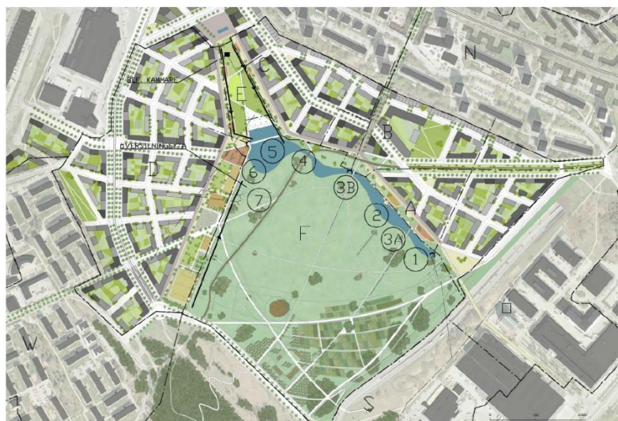
Figur 5-1. Avrinningsområden för planerad exploatering av Årstafälten. Delplanområdet Kvarter G innefattas av delavrinningsområdet A, där dagvatten leds mot Valla Å, vidare mot Valla damm (5). Figur från Sweco (2012).
