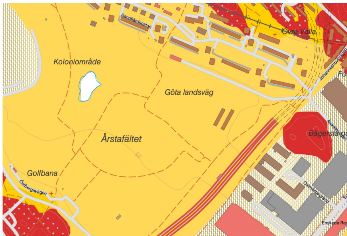
Figur 4. Jordartskarta över Årstafältet. Gul färg visar postglacial lera. (Bild: Sveriges Geologiska Undersökning).
